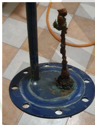
Elektrokémiai korrózió egyik következménye a gyors anódfogyás, ezért indokolt az első anódcseré 12 hónapról, így annak jelentős fogyása esetén még idejében feltárható a probléma a tároló test sérülése nélkül (azt követően 18 hónap).
